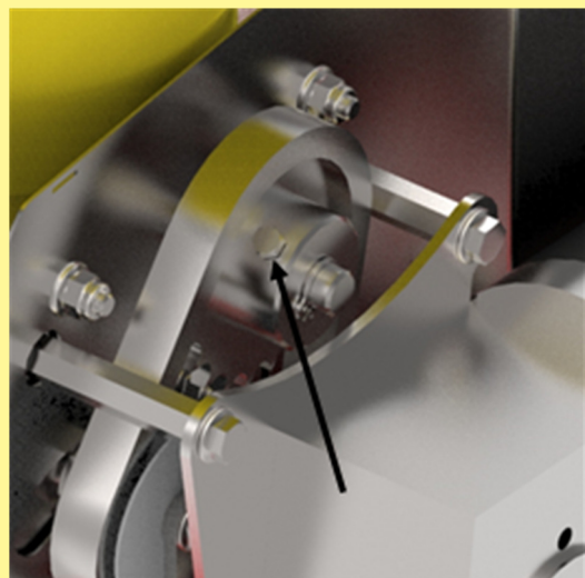
Abbildung 10: Mutter von der Schraube lösen
