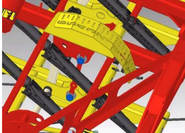
Abbildung 8: neuer Zeiger und Skala am Striegel montiert
