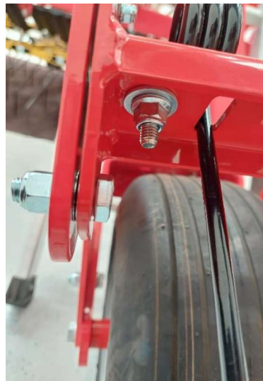
Abbildung 9: Zinkenbefestigung am Tastradstriegel 2
