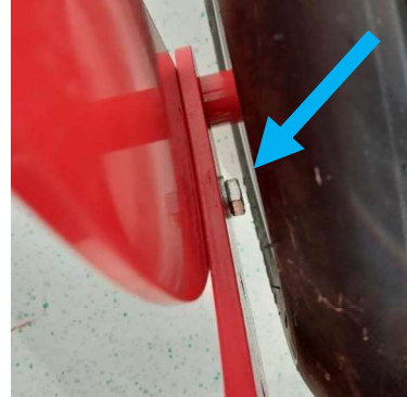
Abbildung 5: Schraubenkopf und Unterlegscheibe innenliegend
