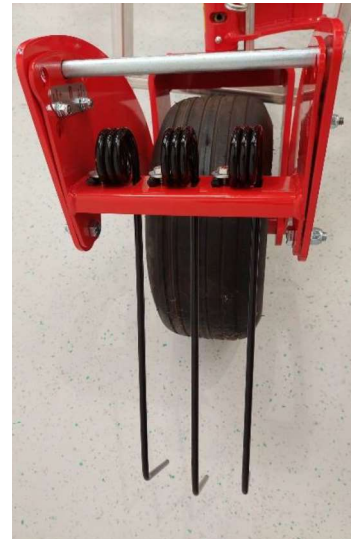
Abbildung 10: Zinkenbefestigung am Tastradstriegel 3
