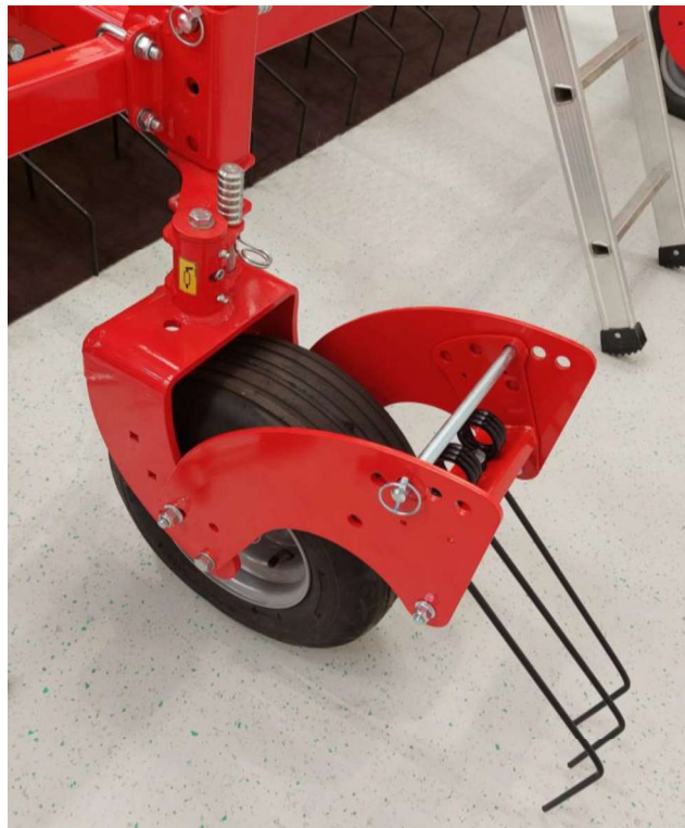
Abbildung 11: fertig montierter Tastradstriegel
