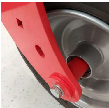
Abbildung 1: Tastradachse ohne Striegel
