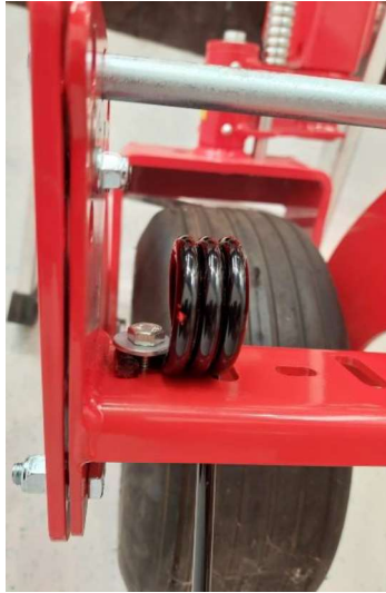
Abbildung 8: Zinkenbefestigung am Tastradstriegel 1
