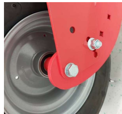
Abbildung 3: Striegel am Tastrad montiert
