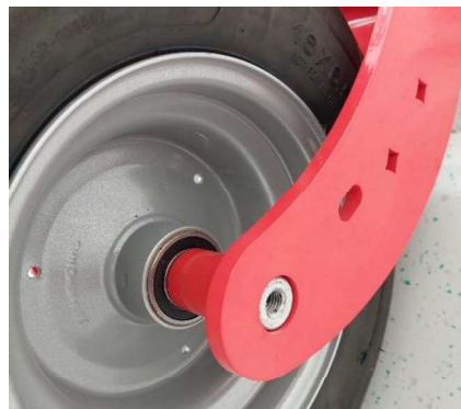
Abbildung 2: Schraube und Scheibe demontiert
