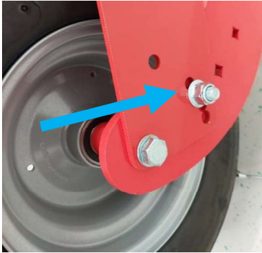
Abbildung 4: Montage am zweiten Loch von oben mit außenstehender Mutter
