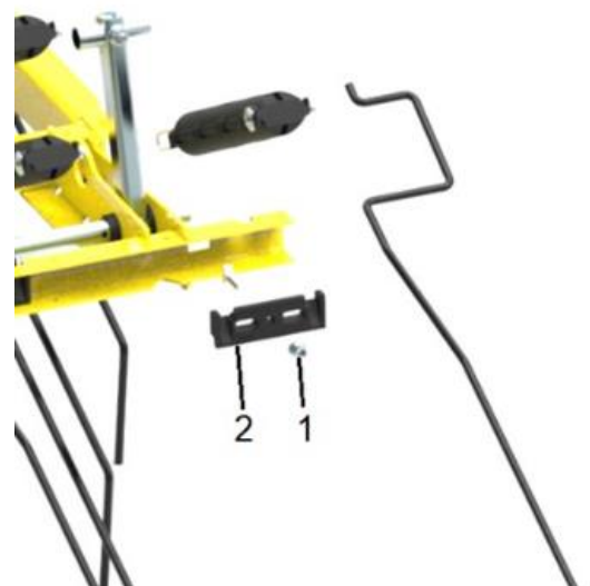
Figura 18: 1 = piuliță, 2 = pachet din plastic
