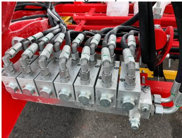
Figura 14: Divizorul de debit de la cadrul central
