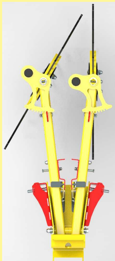
Rysunek 8: Kąt natarcia 30° i 0°
