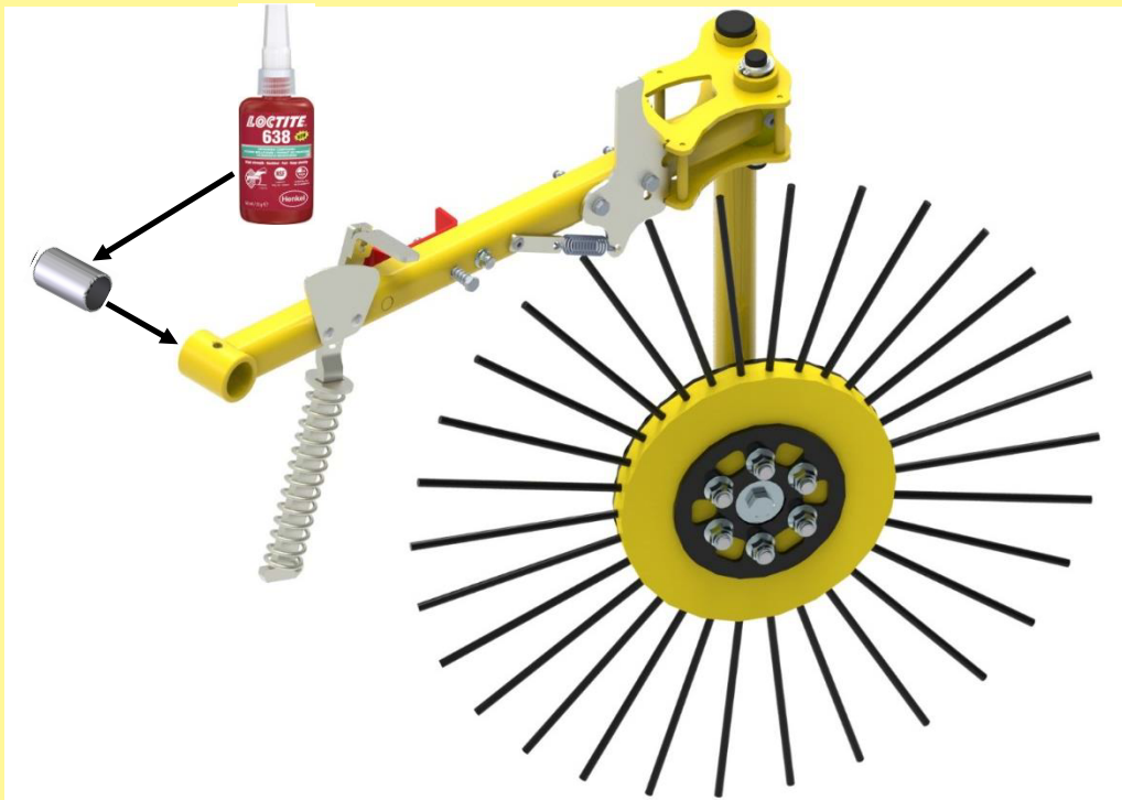
Abbildung 3: Neues Lager mit Loctite einkleben
