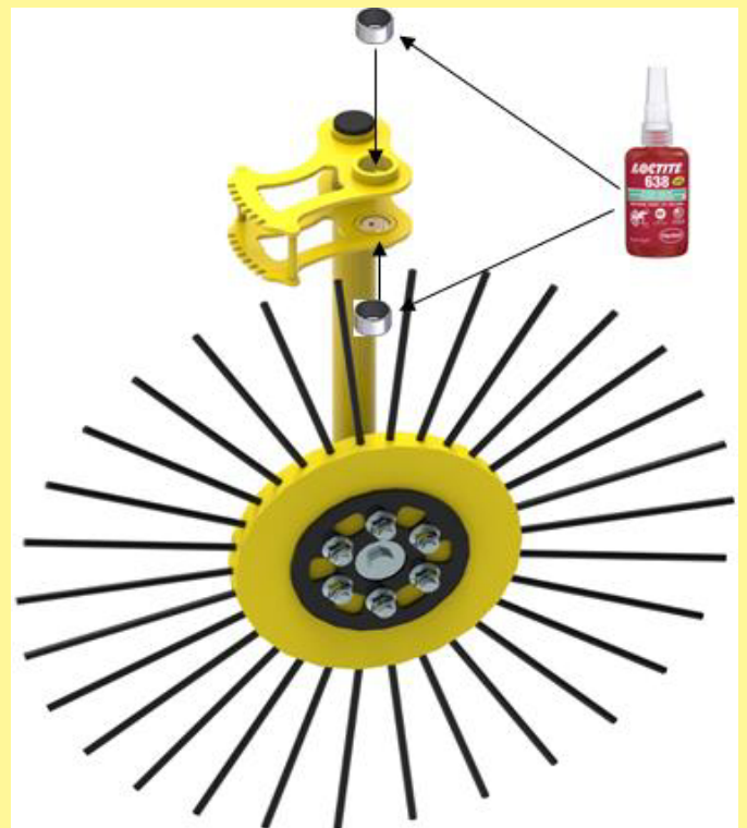
Abbildung 6: Neue Lager am Arm einkleben
