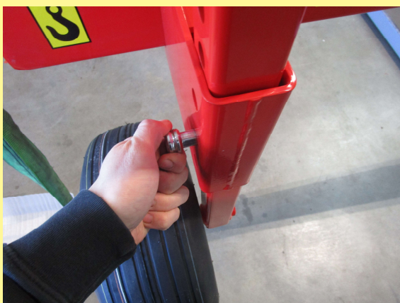
Abbildung 7: Tastrad hineinstecken und mit Bolzen und Klappsplint sichern.
