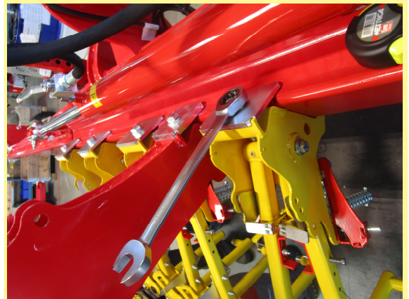
Abbildung 3: Anschrauben des Armträgerpaares.
