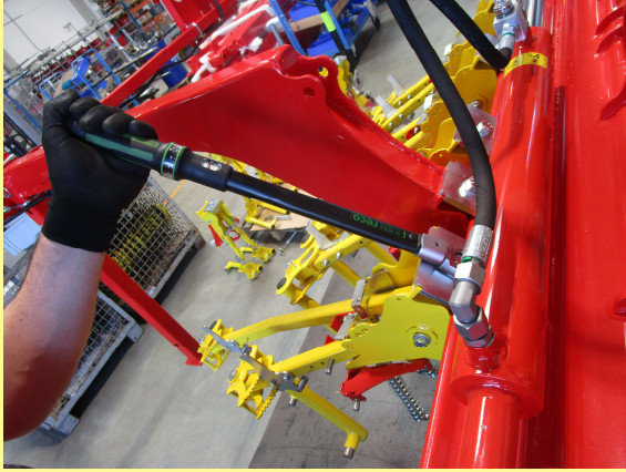
Abbildung 4: mit Drehmoment festziehen.
