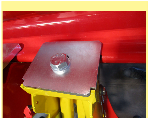
Abbildung 2: Platzieren des Armträgerpaares.
