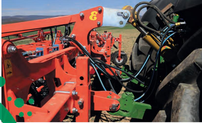
Die Tasträder des Aerostar-Fusion sind schwer, haben aber gute Griffe. Die Nachlaufstriegel sind serienmäßig aufgebaut.
