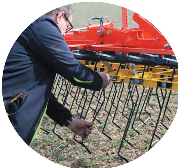
Bei vielen Herstellern lassen sich die Zinken rasch wechseln, da die Feder an der Zinkenhalterung angreift, nicht direkt am Zinken. Die Feder muss man also beim Zinkenwechsel (meist) nicht ausbauen. Die Skala für den eingestellten Zinkendruck sollte für den Fahrer gut sichtbar sein.
