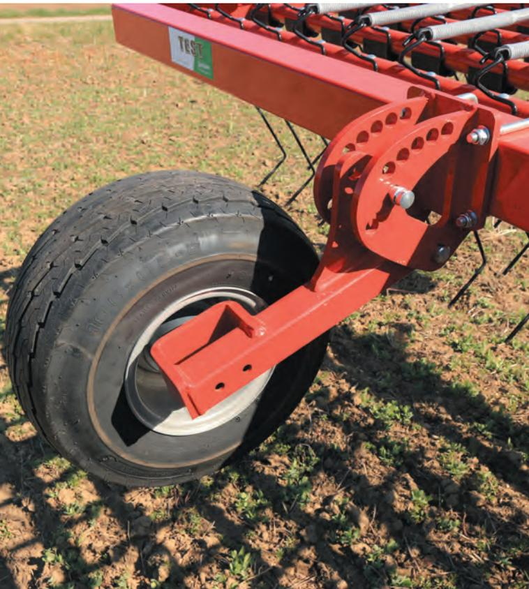
Oben: Gut gefallen hat uns bei Horsch die Verstellung von Höhe und Spurweite der Tasträder.
