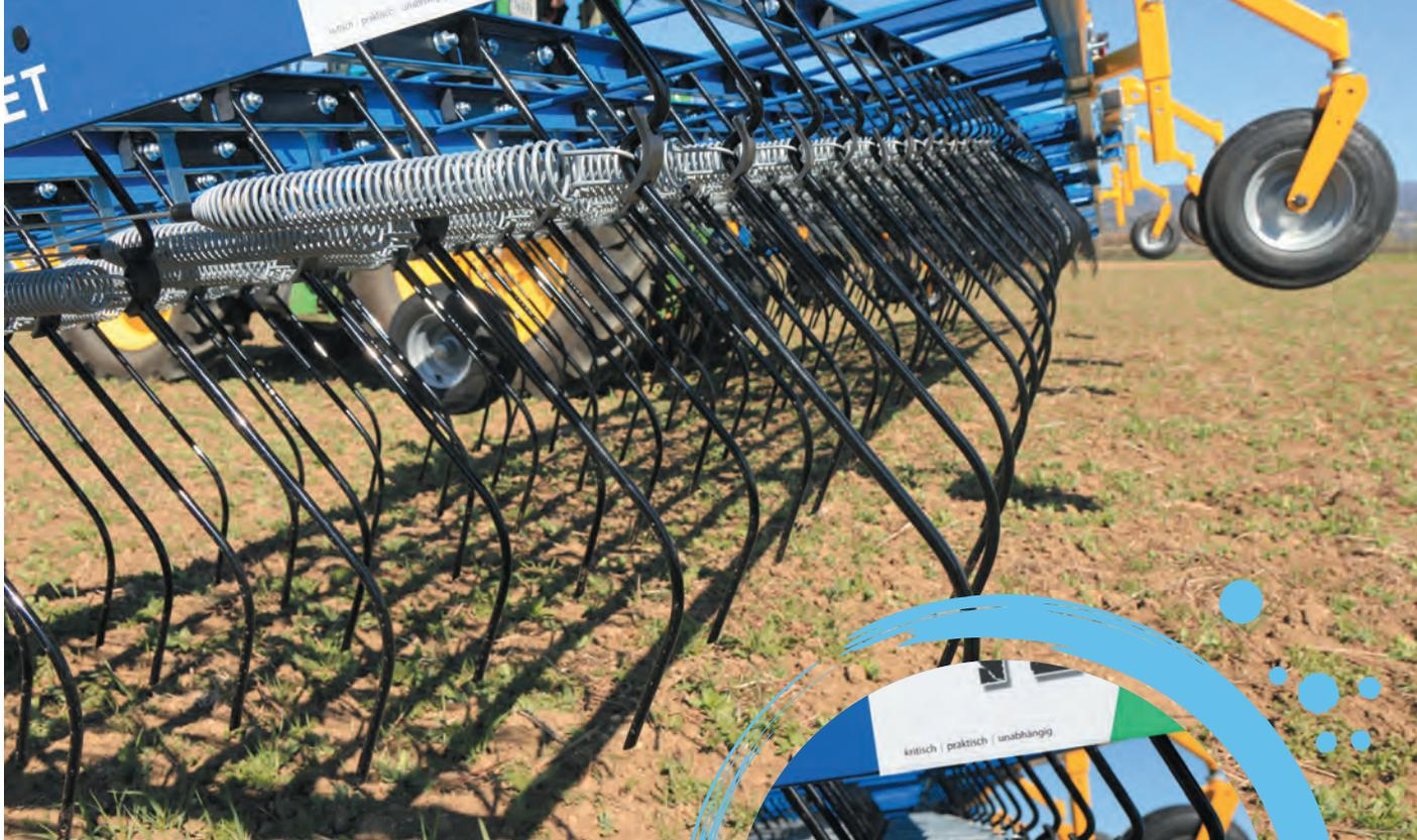
Treffler bietet vier Zinken an: 105 oder 120° sowie mit oder ohne Hartmetall. Im Bild der 120° Hartmetall-Zinken.
