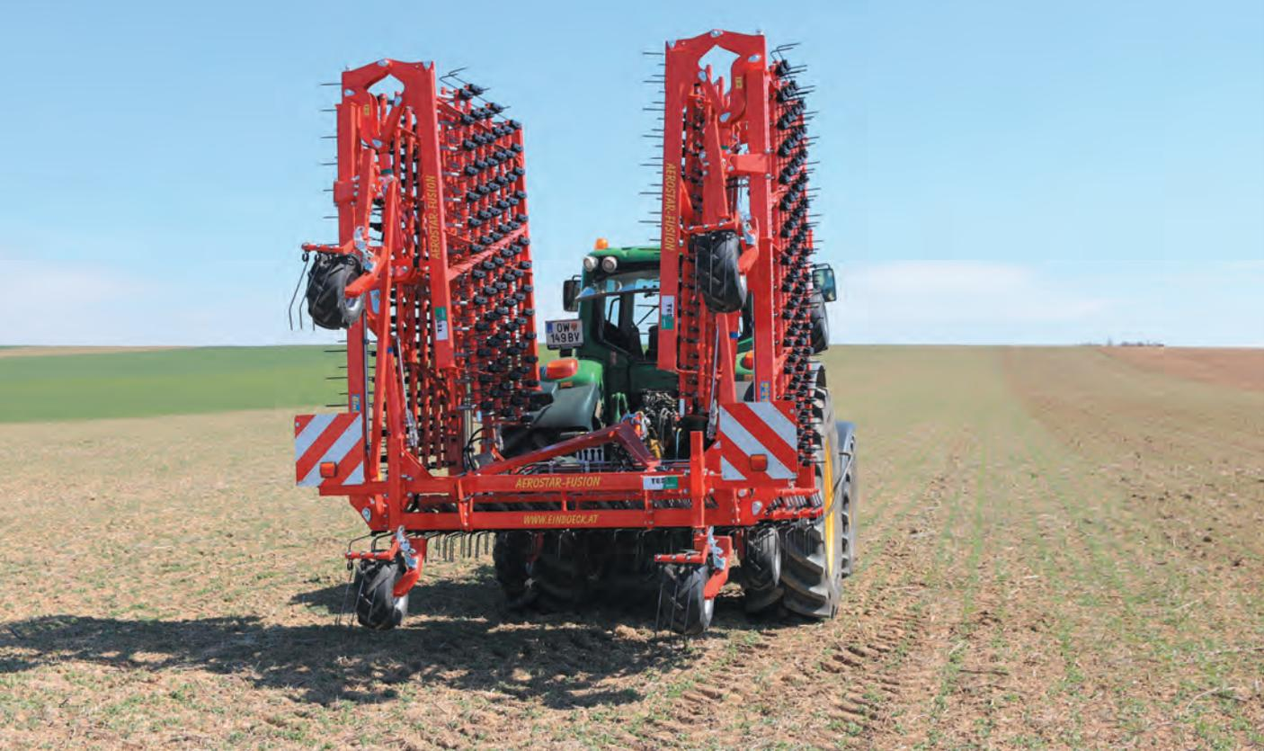
Der Aerostar-Fusion lässt sich erst einklappen, wenn die Zinken ganz eingefahren sind. Das schützt vor einer Fehlbedienung.
