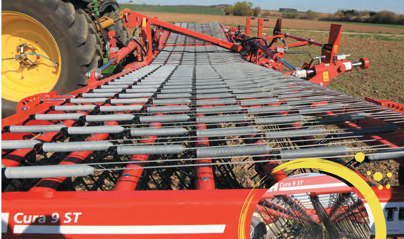
Horsch hat sein System aus Federpaketen und Zugseilen über dem Rahmen verbaut. (Re) Die Standardzinken am Cura ST haben mit 100° einen relativ engen Winkel. Optional gibt es 125°-Mulchsaatzinken.
