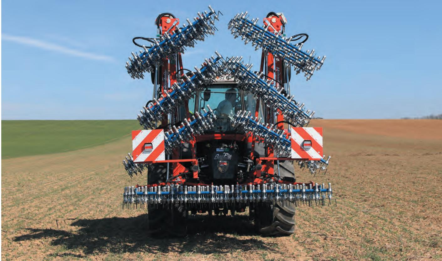
Der Hatzenbichler Air-Flow ist der einzige Exaktstriegel mit Scherenklappung und acht gleich breiten Striegelfeldern.
