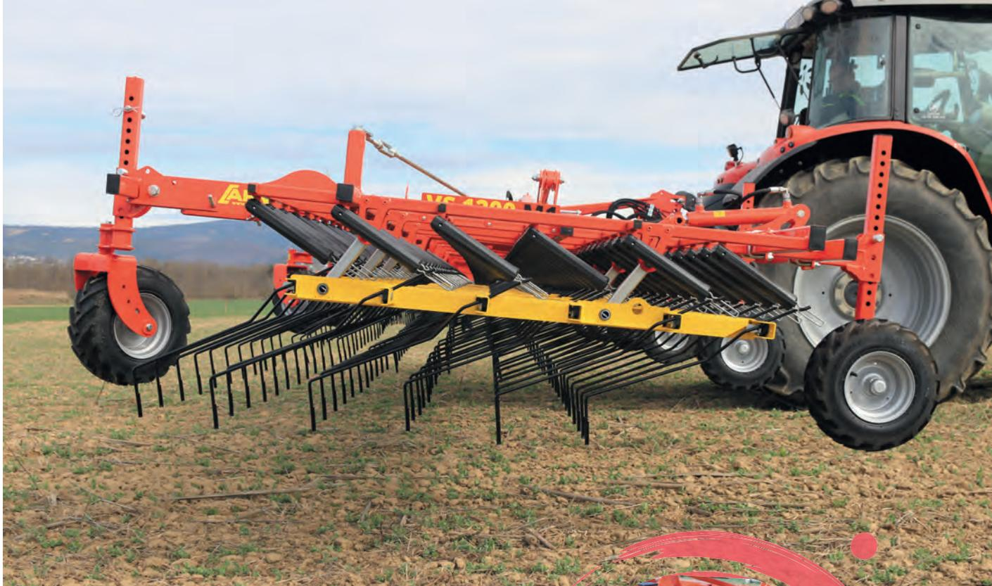
Der gelbe Rahmen wird hydraulisch nach vorne oder hinten verschoben. Dadurch ändern sich die Neigung und der Zinkendruck.
