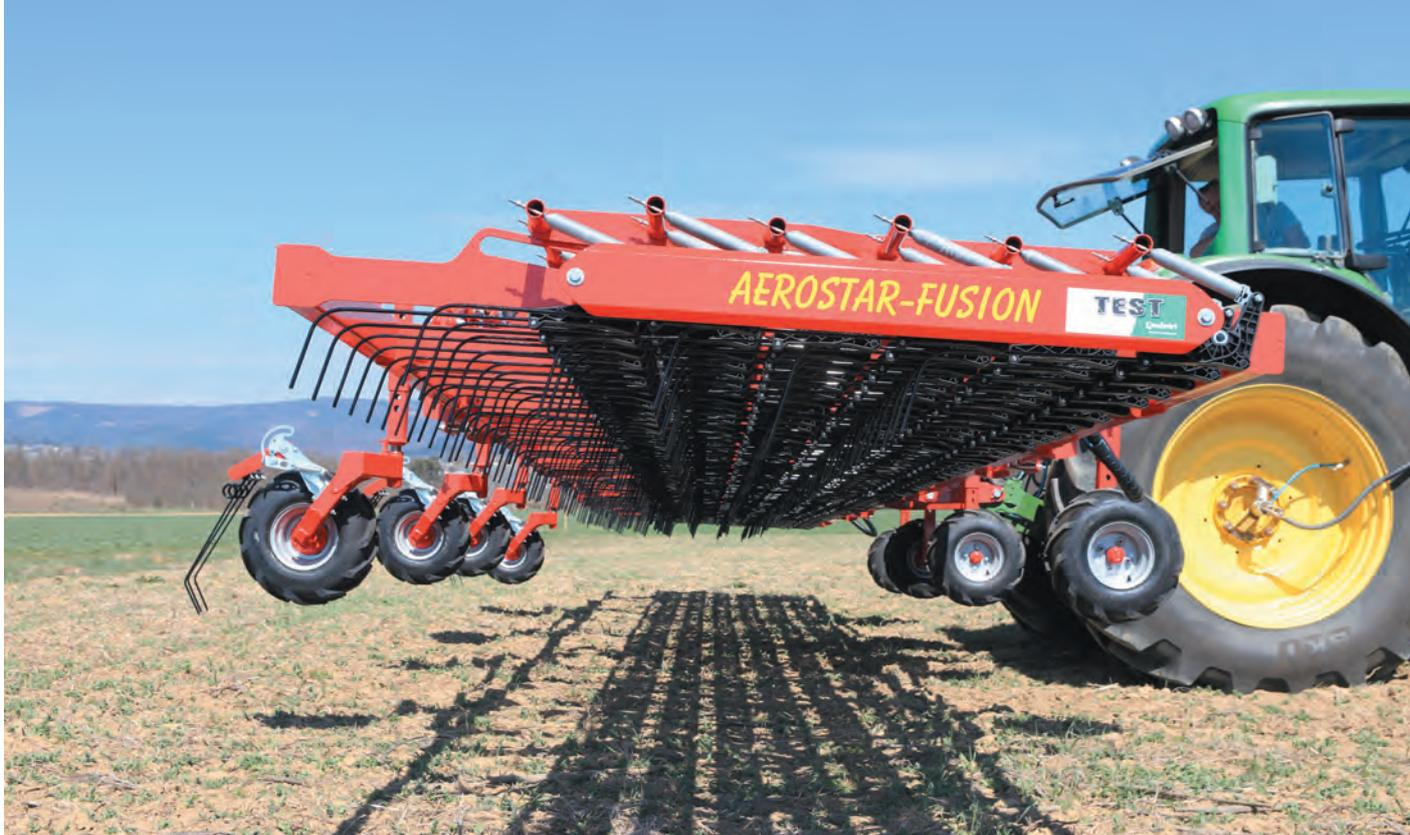
Schwenkt man die Zinken ganz hoch, befreit sich der Einböck-Striegel „selbstständig“ vor allfällig mitgeschlepptem Mulchmaterial.
