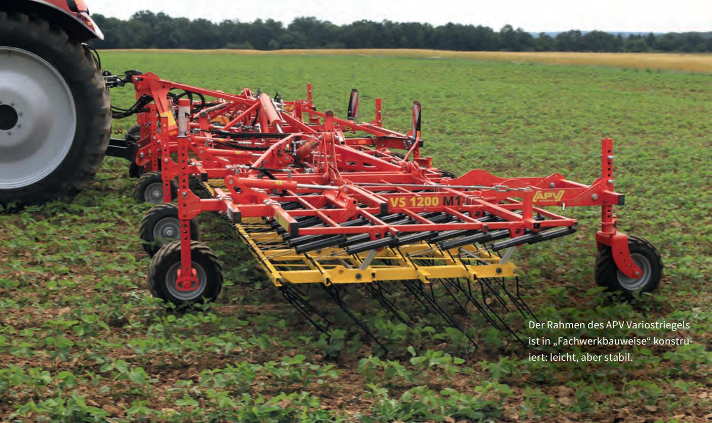
Der Rahmen des APV Variostriegels ist in „Fachwerkbauweise“ konstruiert: leicht, aber stabil.
