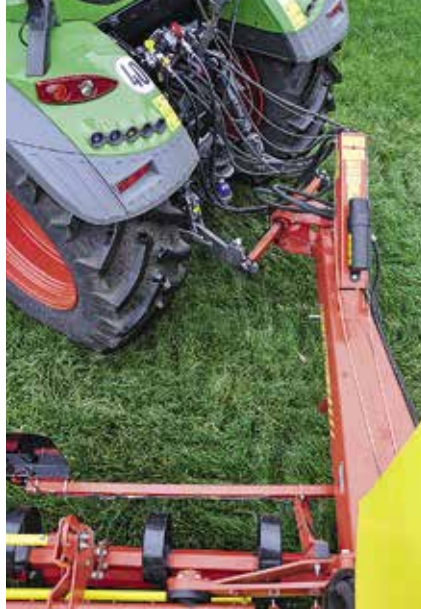
Die lange Deichsel ermöglicht enge Wendemanöver. Fotos: Küper
