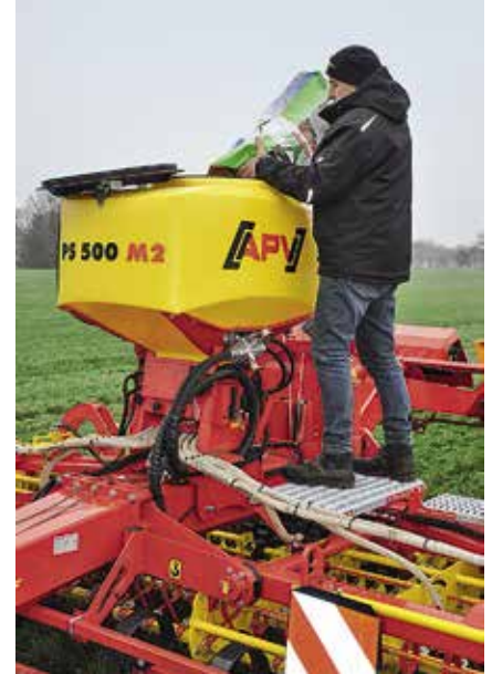
Der Tank befindet sich mittig auf dem Striegel und ermöglicht kurze Wege für das Saatgut.
