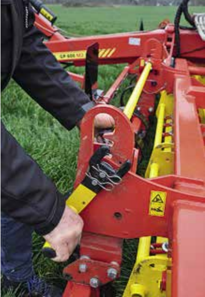
Das Einstellen der Einebnungsbleche funktioniert mit der Zahnstangenkurbel problemlos.
