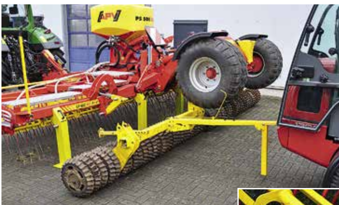
Die Walzen lassen sich mit wenigen Handgriffen demonstrieren. Dann übernehmen Stützräder die Funktionen der Höhenführung. Der Tausch klappt mit etwas Übung innerhalb von 15 Minuten.
